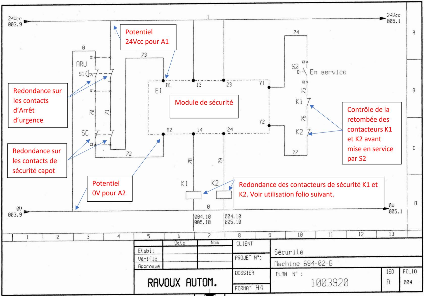
Les 2 contacteurs de sécurité K1 et K2 sont raccordés « en série » pour alimenter le moteur tapis (partie puissance). La probabilité que les 2 contacteurs soient défectueux en même temps est très faible. En plus à chaque mise en service du système, la retombée des contacteurs K1 et K2 (à l'état repos) est vérifiée.
